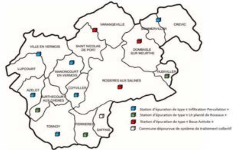
Les communes de **Lupcourt** et de **Ville-en-Vermois** disposent d'une station d'épuration des eaux usées de type Infiltration-Percolation sur sable d'une capacité de 1 200 EH depuis août 2007.
